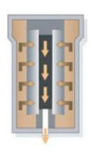
Contrairement à la circulation axiale, la Micro Filtration Radiale de l'huile empêche la formation de canaux entre les couches des média filtrants. Avec la technologie NTF, l'huile traverse de l'extérieur vers l'intérieur chacune des 256 feuilles de la cartouche. La finesse de filtration du micro-filtre est de 2 microns (certifiée ISO). Le filtre fonctionne en continu, purifiant ainsi durablement l'huile présente dans le système.
