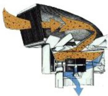
1- A l'entrée du Turbo III, l'air entre en rotation entraînant une turbine.
